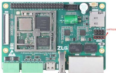
启动串口调试助手，搜索并打开串口模块的设备端口号后，在工程中调用 printf 函数，根据下图可知，printf 函数适配 UART0 设备成功。
