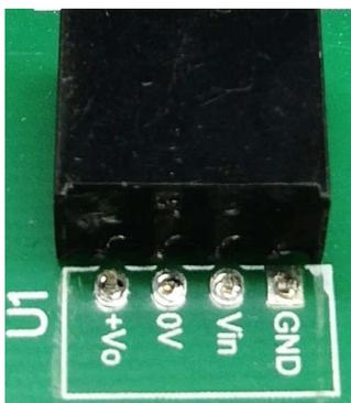
图1 振动场合导致SIP产品的金属引脚疲劳折断图
