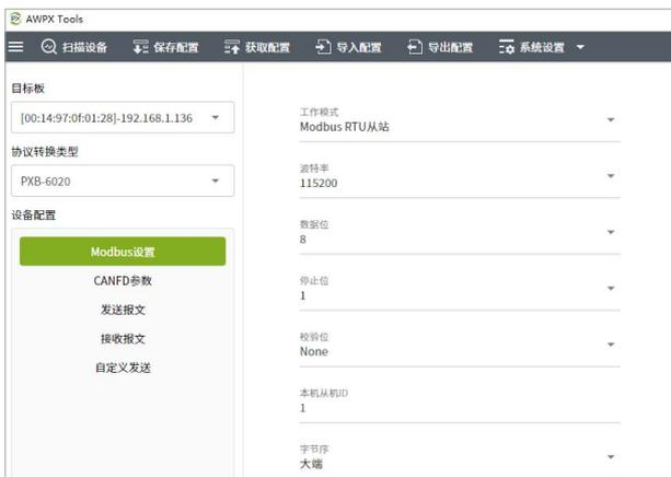
图2 Modbus参数设置
