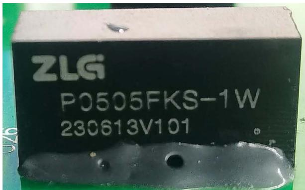
图2 SIP封装电源模块点胶固定图
