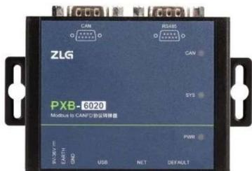
接下来我们将使用 PXB-6020 协议转换器快速实现西门子 S7-200 SMART（以下简称：PLC）的 Modbus 数据转换为 CAN FD 数据，达到 PLC 的 RS485 接口也可以与 CAN FD 设备通信的效果。PLC 运行 Modbus RTU 主站，而 PXB-6020 协议转换器运行 Modbus RTU 从站。
